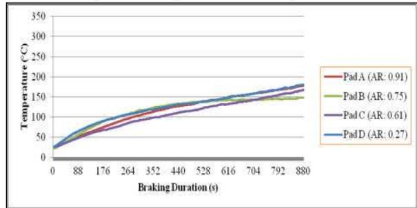
(d) Low speed-Med pressure (185 rpm, 2.5 b)
