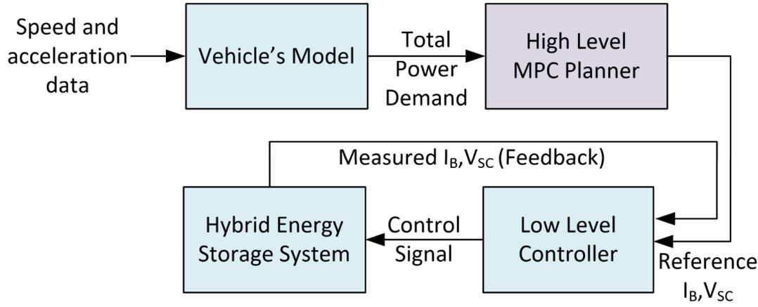
Fig. 1. System Diagram
