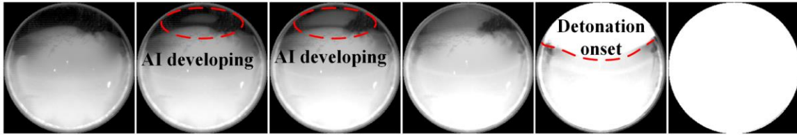
(a) 0.627 ms (b) 0.64 ms (c) 0.657 ms (d) 0.672 ms (e) 0.687 ms (f) 0.695 ms
