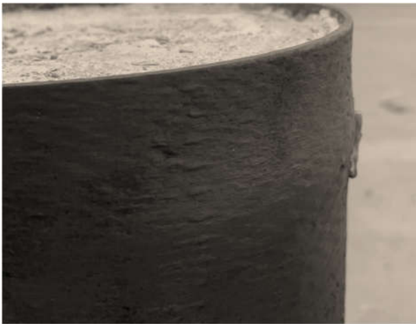
(d) Local buckling of CF-L500D240T4 specimen
