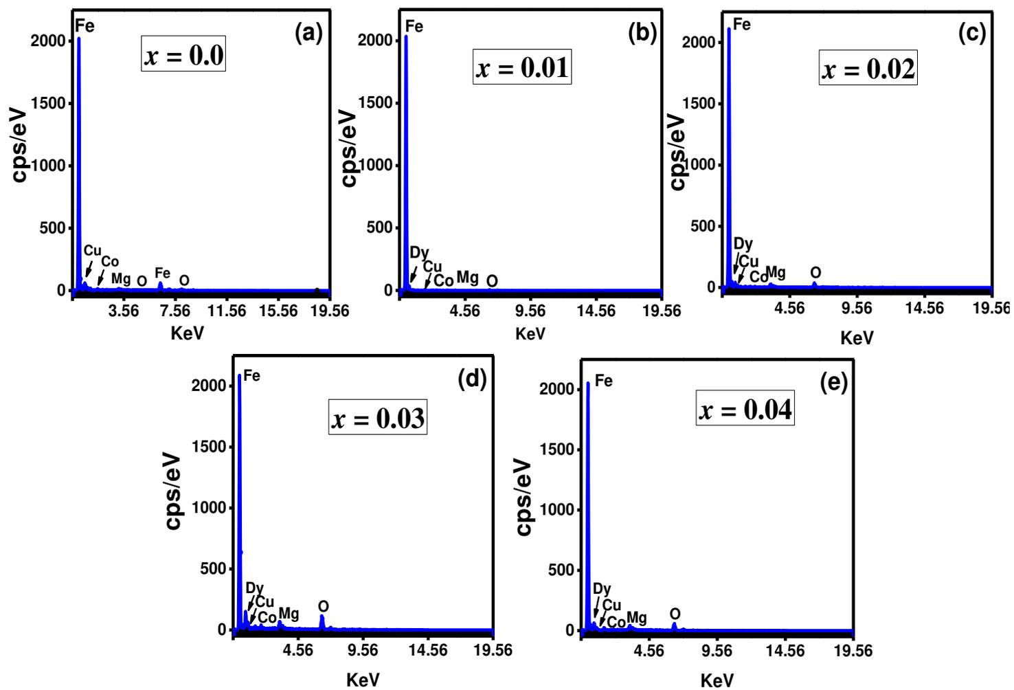
Fig. 4. EDS spectra of *MCCD-soft ferrites*
