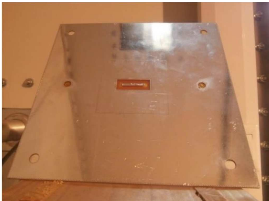
Laird SE test jig - open
