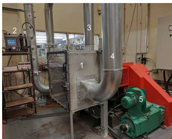
Fig. 1. Brake dynamometer set-up: 1) Enclosure. 2) Dekati ELPI+. 3) Inlet pipe. 4) Outlet pipe. 5) 45 kW motor
