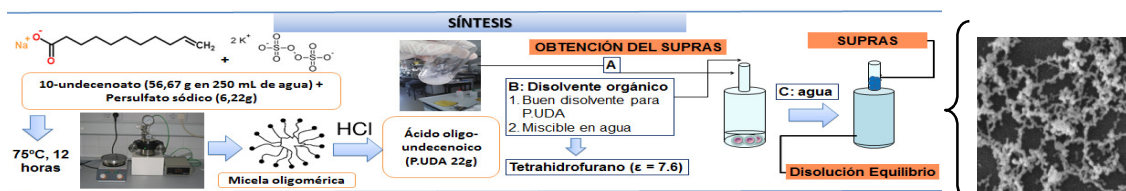
Fig.1: Síntesis del SUPRAS basado en P.UDA:THF:H 2 O y microfotografía Cryo-SEM
