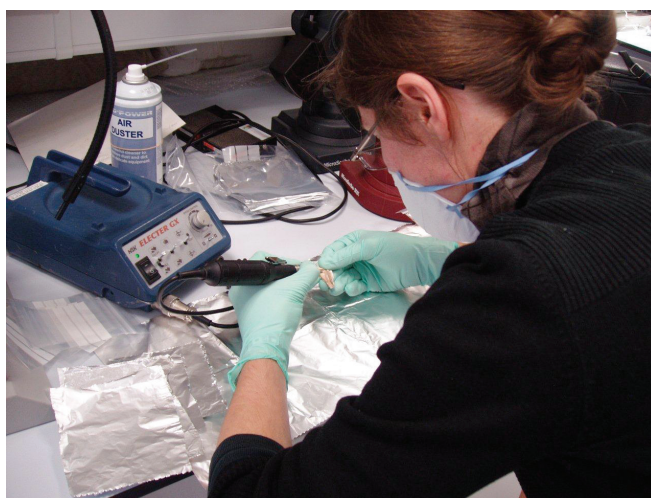
Figura 4. Toma de muestras para la detección radiocarbónica por ultrafiltración por parte de R. Woods en el Grahame Clark Laboratory del McDonald Institute for Archaeological Research (Cambridge). Foto: A. B. Marín Arroyo).
